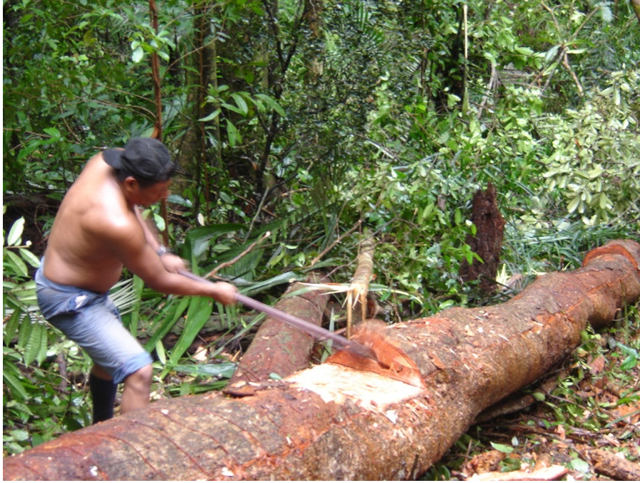
Figure 14 : Préparation de l'évidage de la grume (Cliché J. A. Charles/Karisko)
