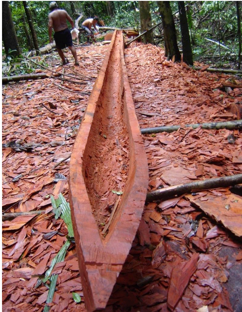
Figure 18 : Coque en cours de mise en forme à l'herminette (Cliché J. A. Charles/Karisko)
