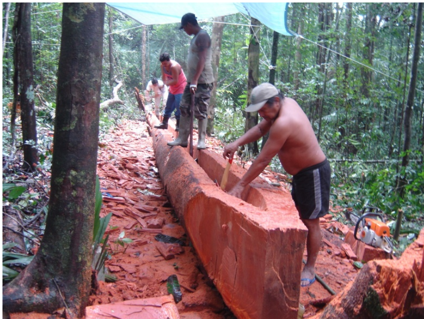
Figure 15 : Première phase de l'évidage de la grume (Cliché J.-A. Charles/Karisko)
