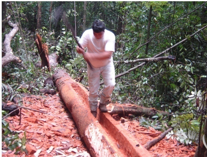
Figure 16 : Ecorçage de la coque (Cliché J. A. Charles/Karisko)
