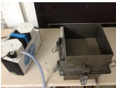
Figure 18 : Dispositif pour l'élaboration, en présence d'un excès d'eau, des plaques de composites fibres végétales/ciment
