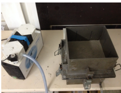
Figure 18 : Dispositif pour l'élaboration, en présence d'un excès d'eau, des plaques de composites fibres végétales/ciment
